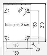
Допустимая нагрузка для каждого отверстия минимум 30 000 Н (например, винт M12)
